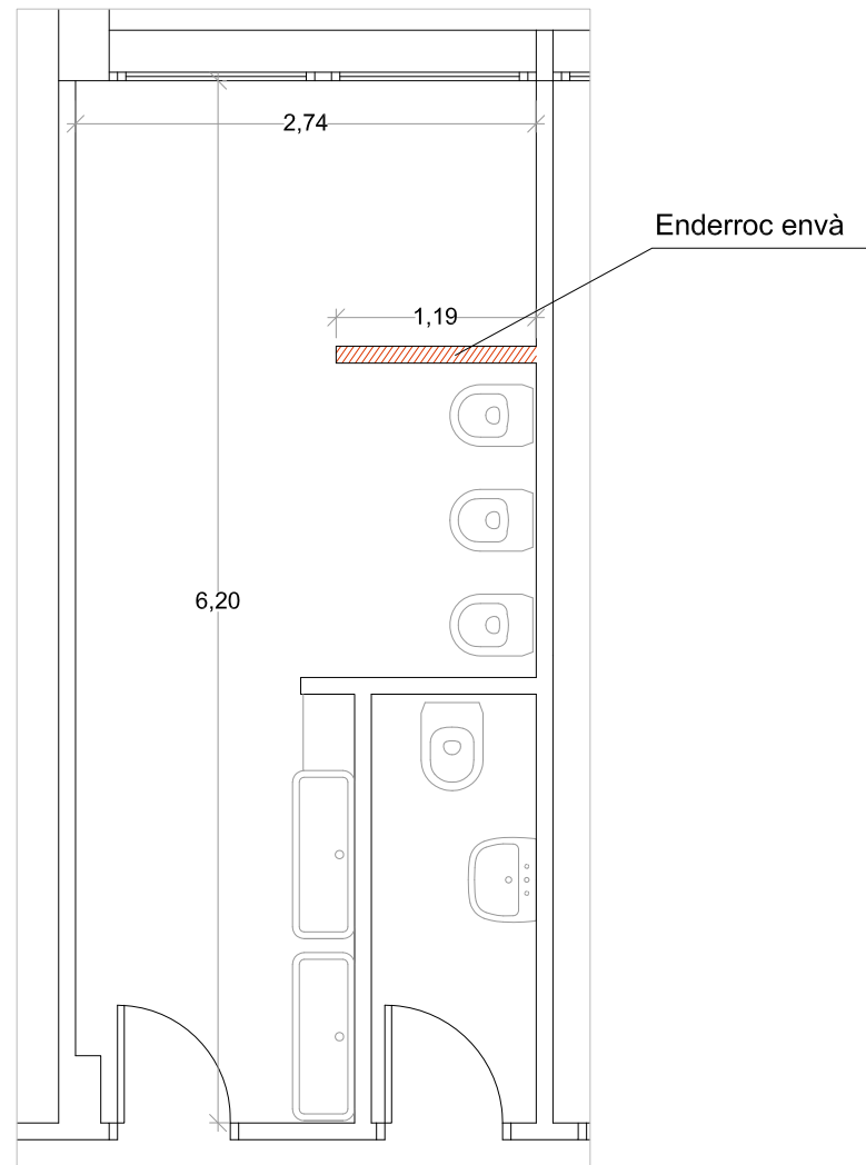
ESTAT ACTUAL Edifici parvulari P3 _ B05 E:1/50
