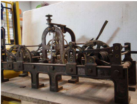
Fabricant: Henry Lepaute 1892 Estructura de ferro amb peces d'acer i bronze. Completament restaurat
